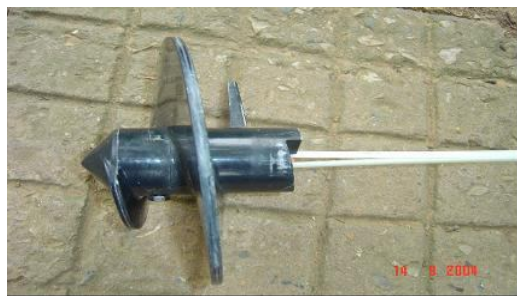
图 1 玻璃钢螺旋锚的锚头和锚杆
